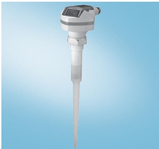
El transmisor por radar pulsado SITRANS Probe LR incorpora una cable de potencia de 2 hilos y una frecuencia de 6 GHz para la medición de nivel continua de líquidos y lodos en depósitos de almacenamiento. Es apropiado para rangos de medida hasta 20 m (66 ft) y aplicaciones con presión y temperaturas nominales.
