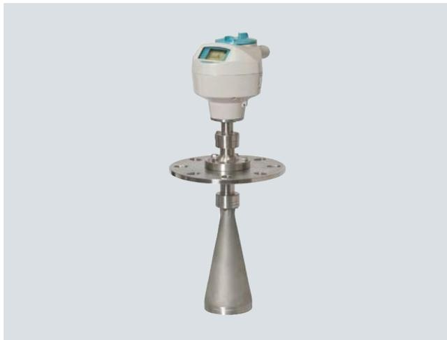
El transmisor de nivel SITRANS LR260 por radar a impulsos a 2 hilos y 25 GHz monitoriza continuamente el nivel de sólidos en tanques de almacenamiento con polvo y temperaturas extremas, en rangos hasta 30 m (98.4 ft).
