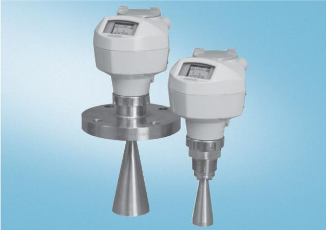
El transmisor por radar pulsado a 2 hilos SITRANS LR250 mide el nivel de líquidos y lodos de forma continua en depósitos de almacenamiento y recipientes de proceso con presión y temperaturas extremas, en rangos hasta 20 m (66 ft).
