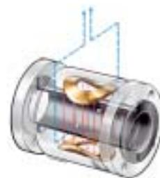
Las bobinas en el sensor generan un campo magnético estable. El líquido que fluye a través del sensor induce una tensión proporcional a la velocidad del fluido.
